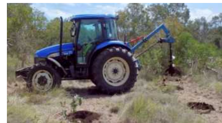
3 Trouaison à la tarière montée sur tracteur
