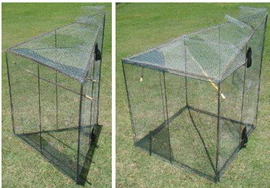
Figure 7 : Modèle des deux nouveaux prototypes de pièges-cages mis en place et testés sur Tontouta (à gauche : PC1 ; à droite PC2)
