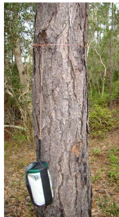
Dispositif d'alarme activé par basculement du boîtier
