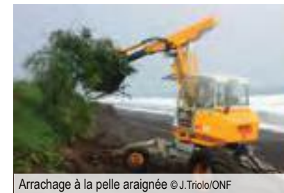
Arrachage à la pelle araignée © J.Triolo/ONF
