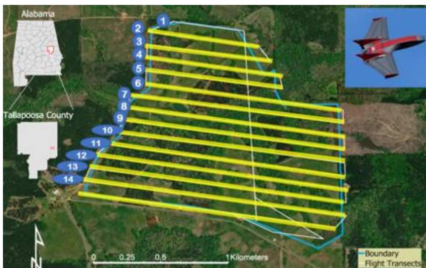
Figure 6 : Exemple de Trajectoire de vol (lignes blanches) en blocs (balayage de zone en forme de polygone) et transects parcourus (surlignés en jaune et étiquetés) tiré de l'étude de Beaver et al. 2020 pour des relevés thermiques par drones sur le cerf de Virginie
