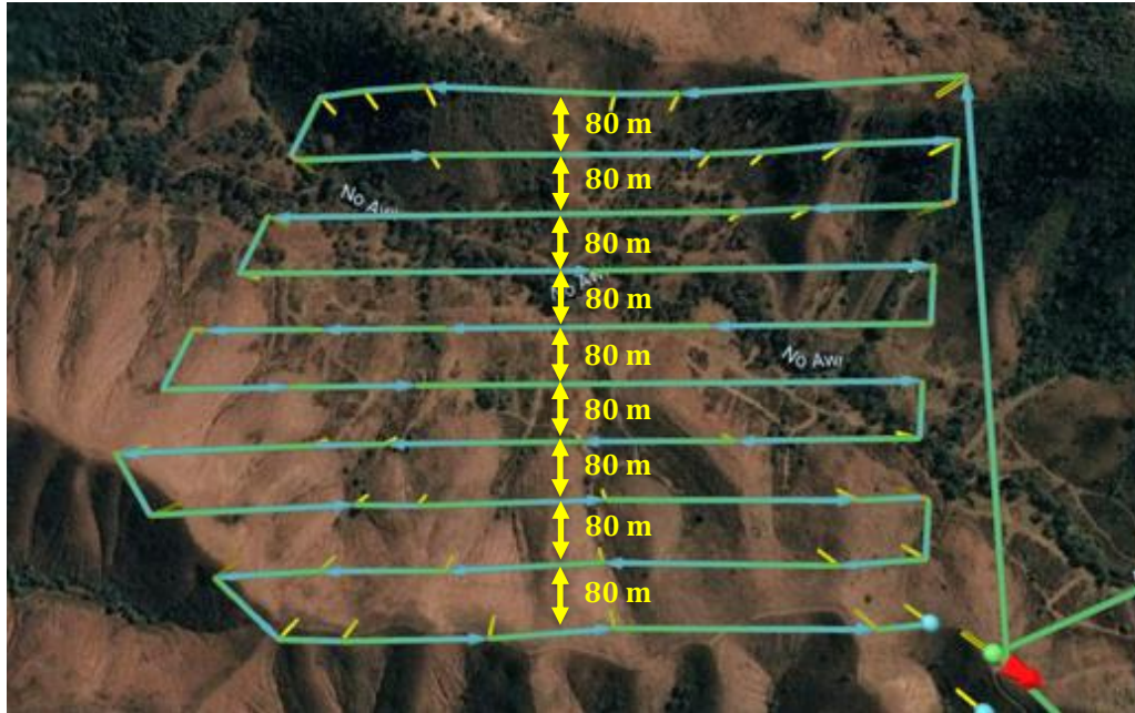
Figure 24 : Exemple d'un plan de vol réalisé sur le Domaine de Déva en mode balayage de zone et suivi de terrain avec un espacement des lignes de 80 m
