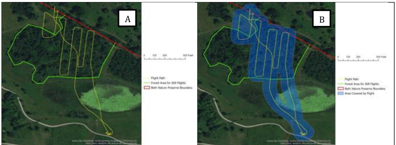
Figure 8 : Exemple de trajectoire de vol en bande de comptage (Strip transect) tiré de l'étude de Maxwell C. Ott, 2020, sur l'utilisation des drones avec un capteur thermique pour cartographier et compter les populations de cerf (En (A) trajectoire de vol simple et (B) trajectoire de vol avec la surface au sol couverte par le vol/capteur). Le chemin étrange emprunté dans la partie supérieure gauche du chemin est dû à l'observation d'un groupe de cerfs, qui ont été suivis pendant une courte période.
